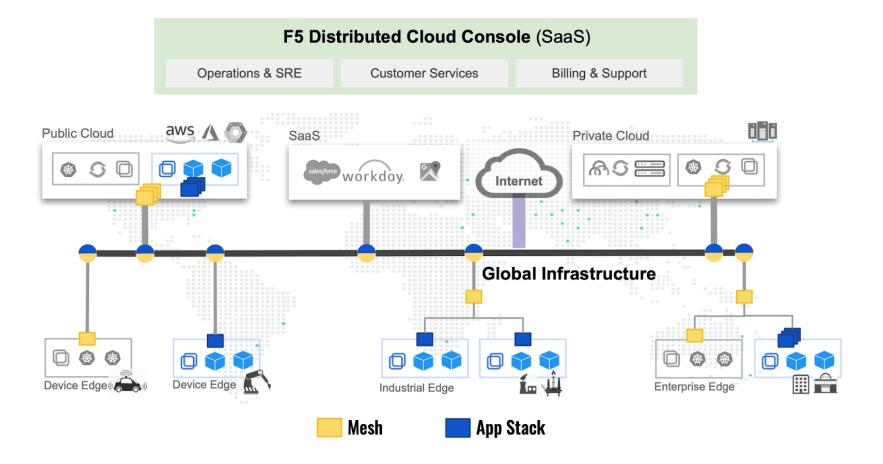
Die obige Abbildung zeigt eine End-to-End-Ansicht, wie App Stack und Mesh Services innerhalb einer einzelnen Cloud, über mehrere Clouds, über mehrere Edge-Standorte und/oder innerhalb der globalen F5 Distributed Cloud-Infrastruktur aktiviert werden können.
